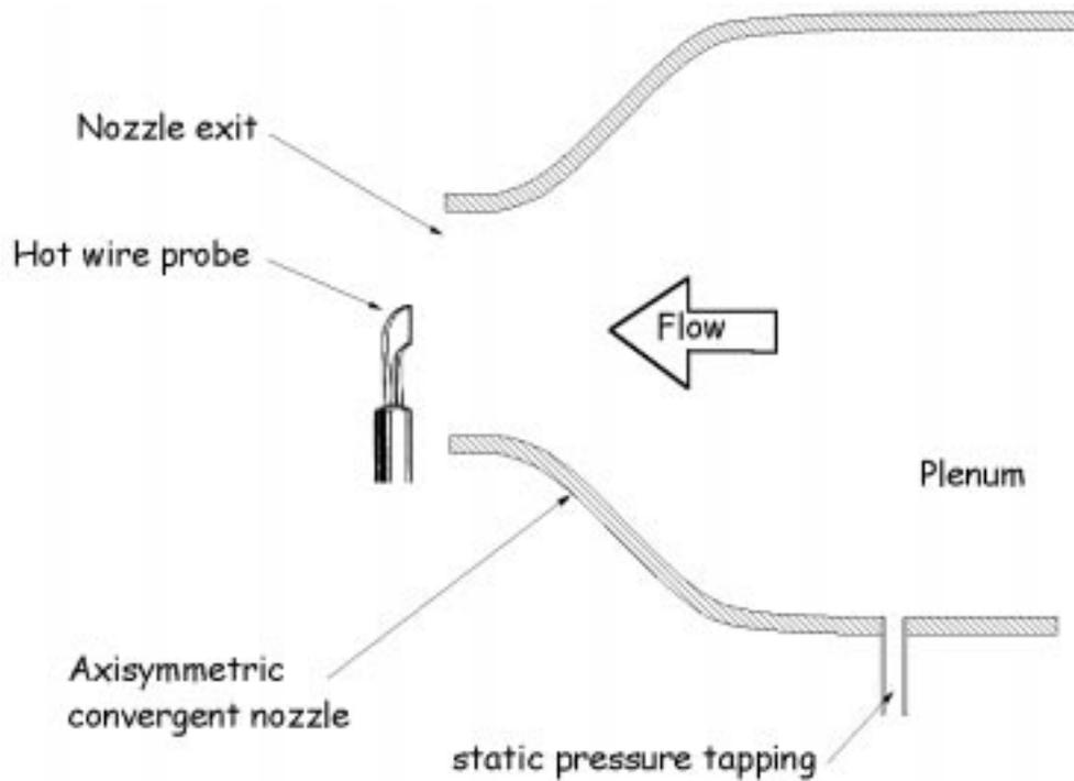
Fig. 6. Hot wire calibration rig.
